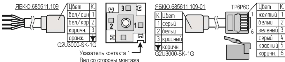
Рисунок 3 – Схема кабелей ЯБКЮ.685611.109 и ЯБКЮ.685611.109-01.
